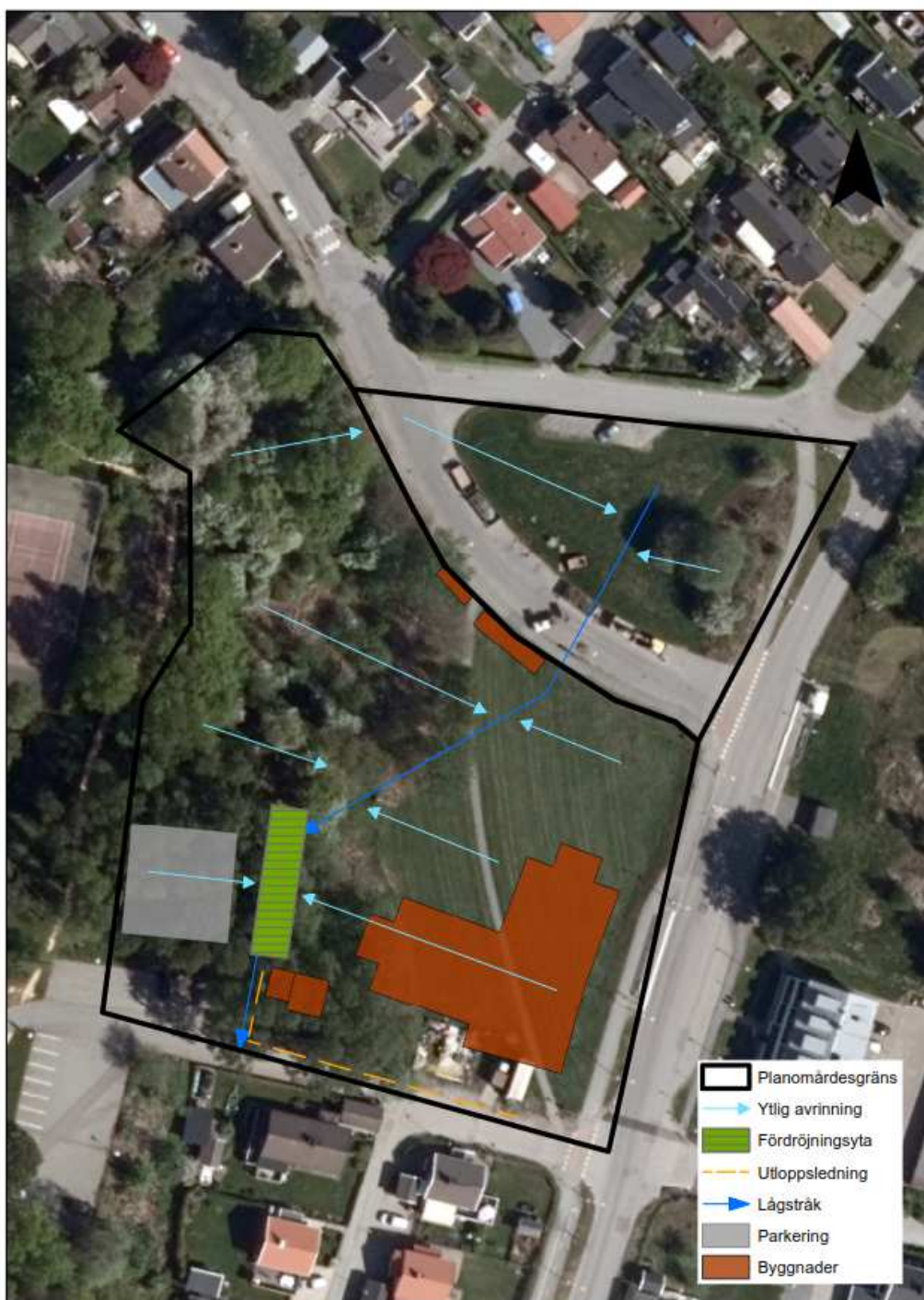
Figur 19. Principförslag för dagvattenhantering inom utredningsområdet.
