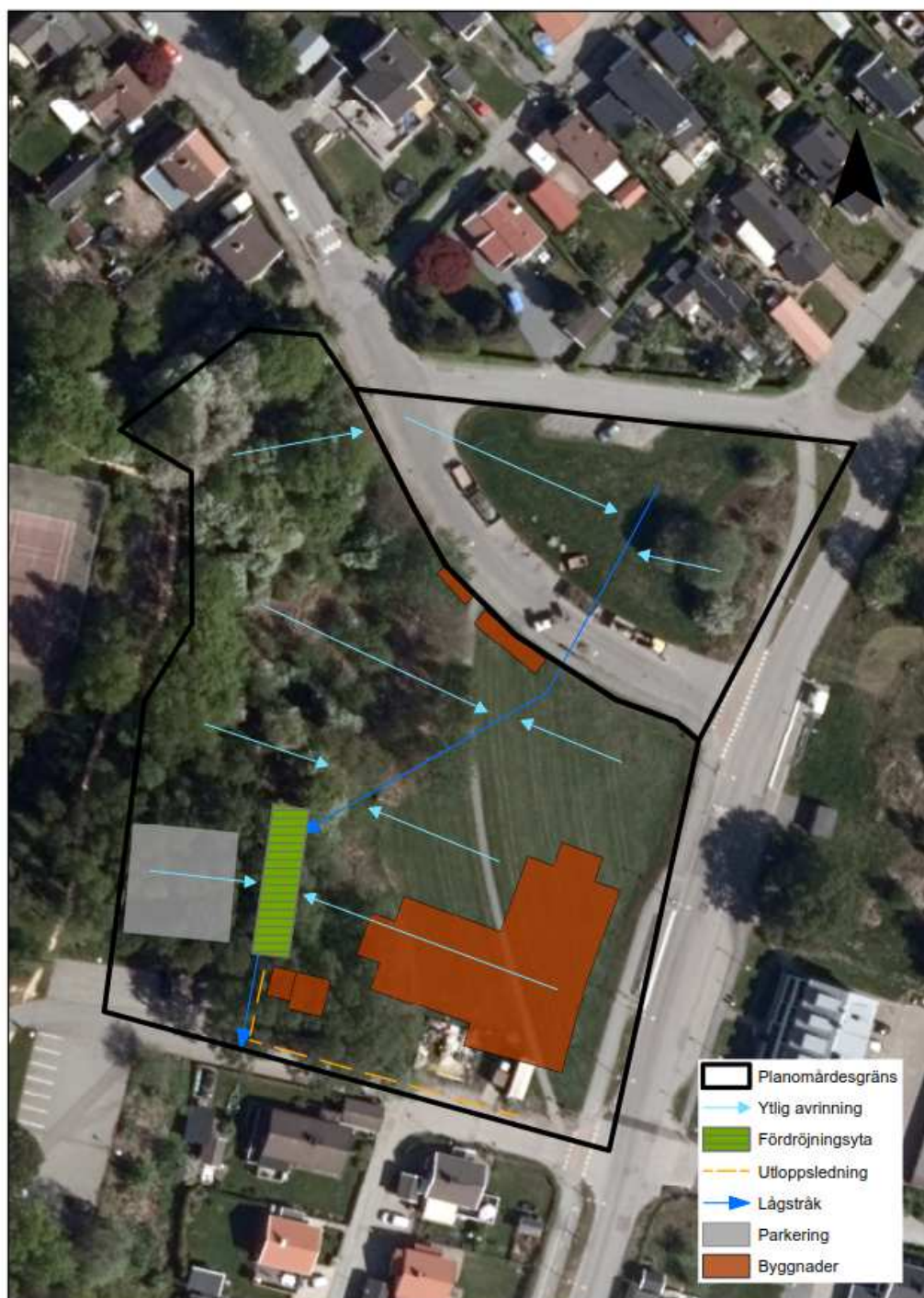
Figur 24 Föreslagen principlösning för storskalig dagvatten- och skyfallshantering.
