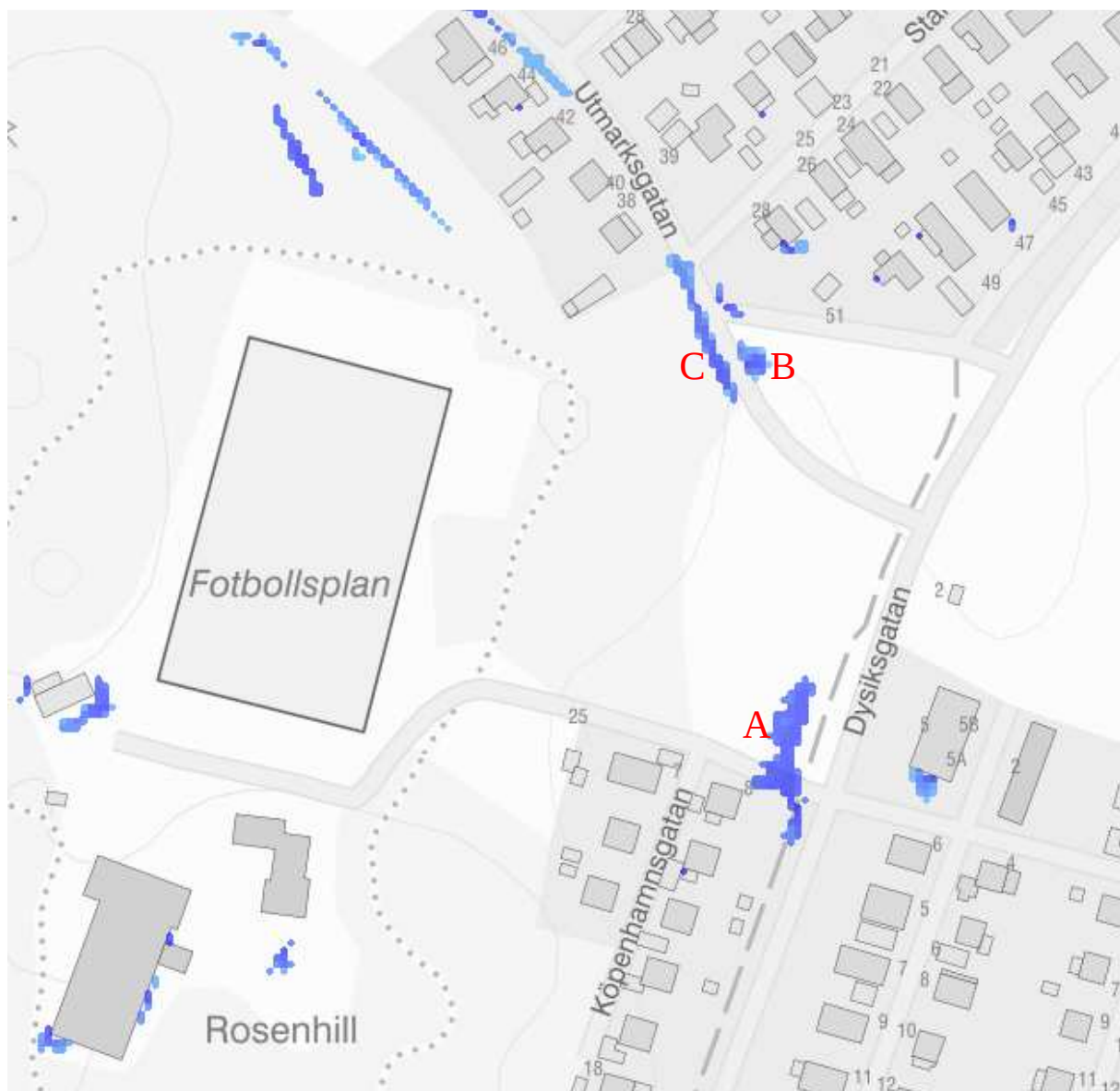
Figur 12. Ansamling av vatten i terrängens lågpunkter vid 1 mm nederbörd modellerat i Scalgo Live.
